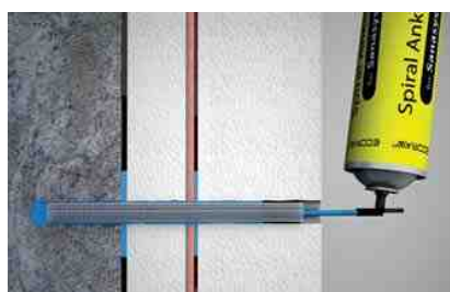
Zdvojení zateplení se souběžnou stabilizací původního zateplení
