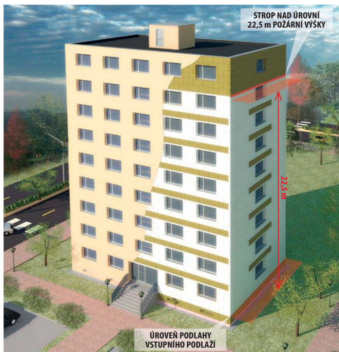
A) Standardní provedení střídáním tepelné izolace EPS s pásy minerální izolace.
