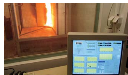
Obr. 3: Isover TWINNER při zkoušce SBI – třída reakce na oheň B-s1,d0
