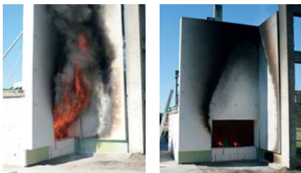
Obr. 11, 12: Vzorek zateplení ETICS s Isover TWINNER v průběhu a po ukončení zkoušky. Zateplení fasády zůstává celistvé a nešíří ani extrémní požár. V průběhu zkoušky nedošlo k žádnému odpadávání ani odkapávání částic zateplení.
