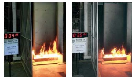
Obr. 4, 5: Isover TWINNER a zateplovací systém ETICS ve 4. a 30. minutě zkoušky dle ISO 13 785-1 a národní přílohy NA. K šíření požáru ani k odkapávání nedochází.
