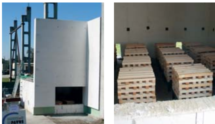
Obr. 9, 10: Vzorek ETICS s Isover TWINNER připravený ke zkoušce dle ISO 13 785-2. Zdrojem extrémního tepelného výkonu při zkoušce jsou normové hranice vysušeného řeziva.
